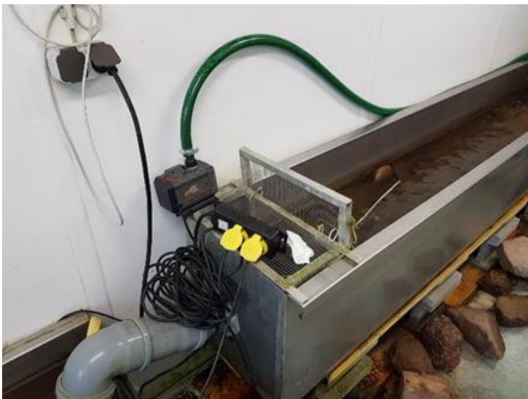
Abb. 4 Herstellung des temporären geschlossenen Kreislaufs in der Muschelrinne. Eine Teichpumpe wird am flussabwärtigen Ende der Muschelrinne eingebracht (links), diese pumpt das Wasser über einen Schlauch zum flussaufwärtigen Ende (rechts).
