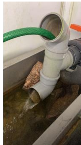
Abb. 4 Herstellung des temporären geschlossenen Kreislaufs in der Muschelrinne. Eine Teichpumpe wird am flussabwärtigen Ende der Muschelrinne eingebracht (links), diese pumpt das Wasser über einen Schlauch zum flussaufwärtigen Ende (rechts).
