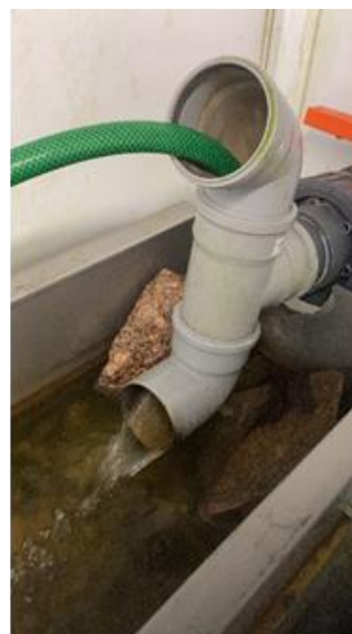
Abb. 2 Herstellung des temporären geschlossenen Kreislaufs in der Muschelrinne. Eine Teichpumpe wird am flussabwärtigen Ende der Muschelrinne eingebracht (links), diese pumpt das Wasser über einen Schlauch zum flussaufwärtigen Ende (rechts).
