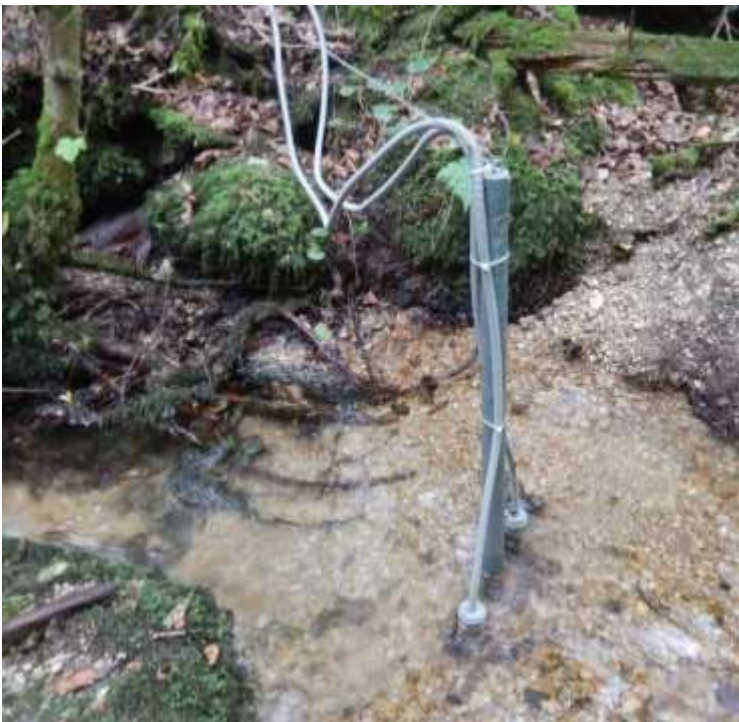
Abb. 3 RedOx-Potential-Sonden im Käfermühlbach. Die Sonden sind über ein Brett mit einem im Gewässerboden verankerten Plastiksteher verbunden. Über die in PVC-Schläuchen verlaufenden Kabel werden die Daten an die am Ufer befestigten Fernübertragungsmodule weitergeleitet.
