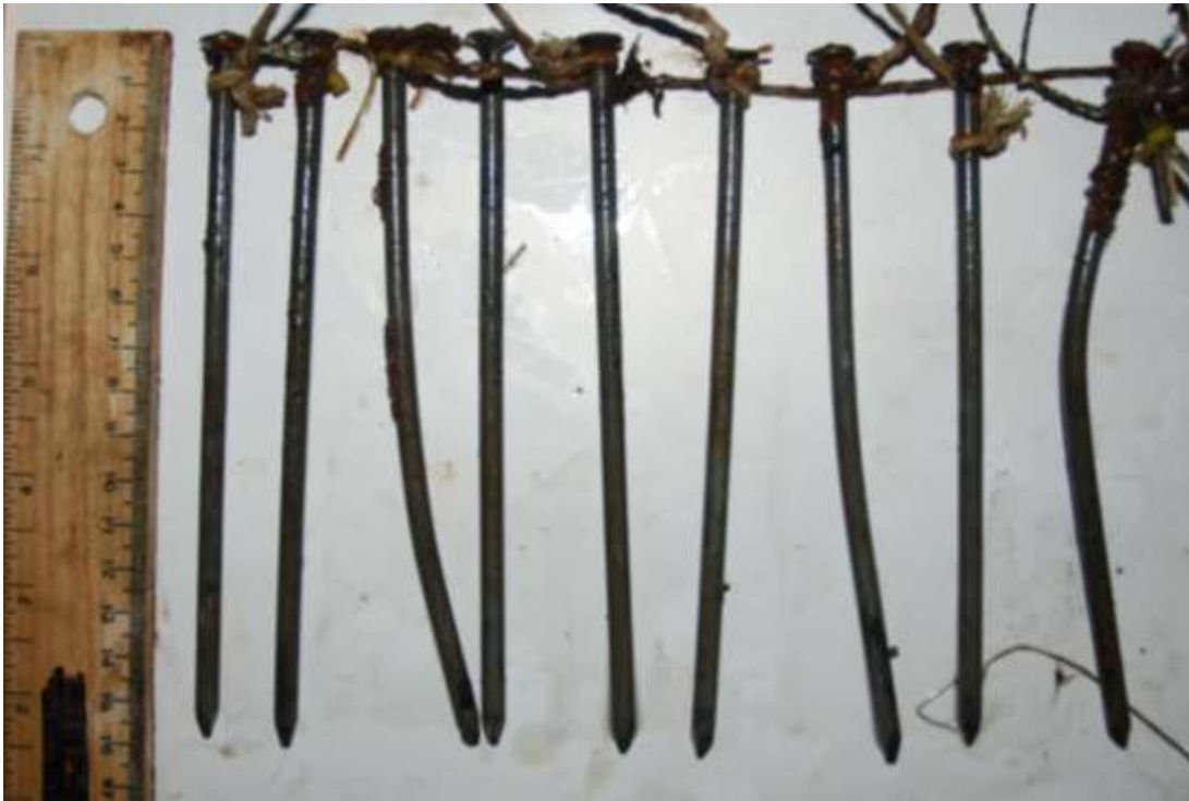
Abb. 10 „Nagelprobe“ Schwarze Aist – flussauf der Flamm bachmündung: Die Nägel zeigen nach drei Monaten im Gewässer einen nur sehr geringen Rostansatz.
