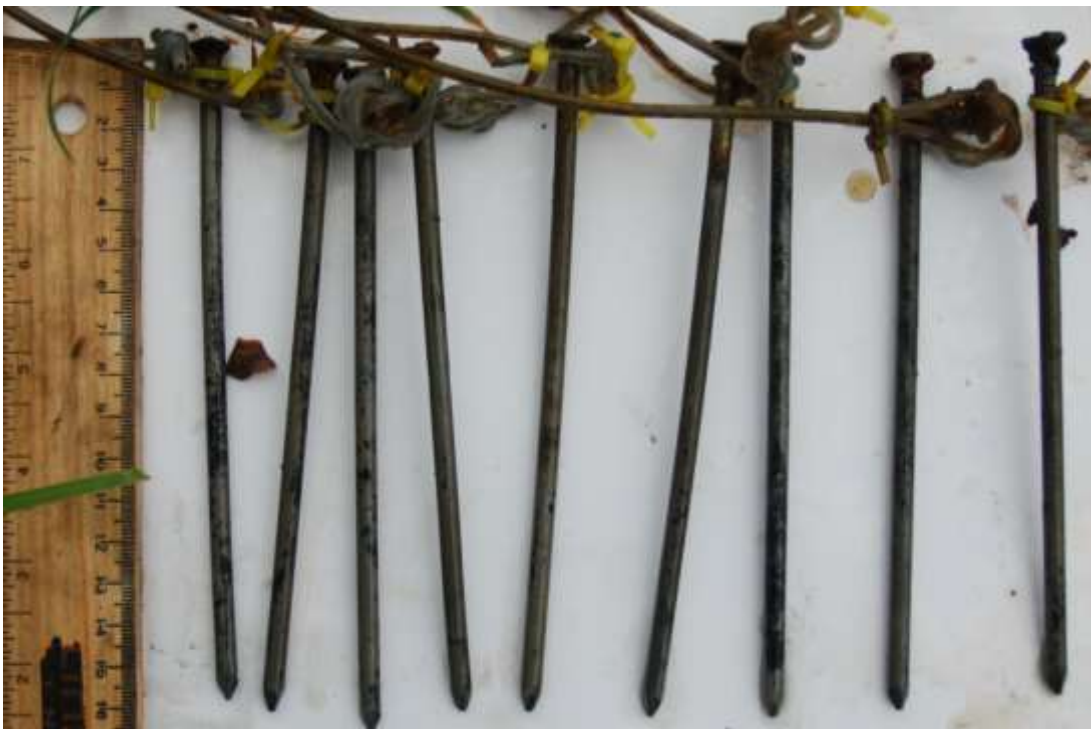
Abb. 11 „Nagelprobe“ Schwarze Aist – flussab von Weitersfelden: Die Nägel zeigen nach drei Monaten im Gewässer einen nur sehr geringen Rostansatz.
