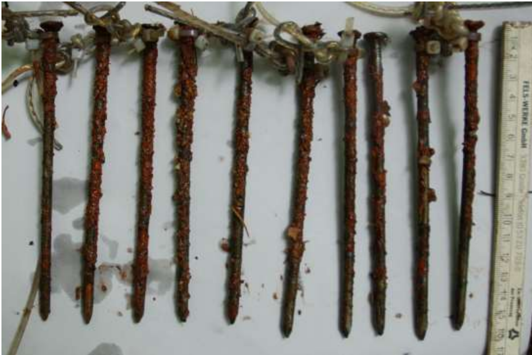
Abb. 12 „Nagelprobe“ Käfermühlbach – zwischen der Großen und der Kleinen Überwachs: Die Nägel sind nach drei Monaten im Gewässer rostverkrustet, dies lässt auf eine sehr gute Sauerstoffversorgung im Gewässer schließen.
