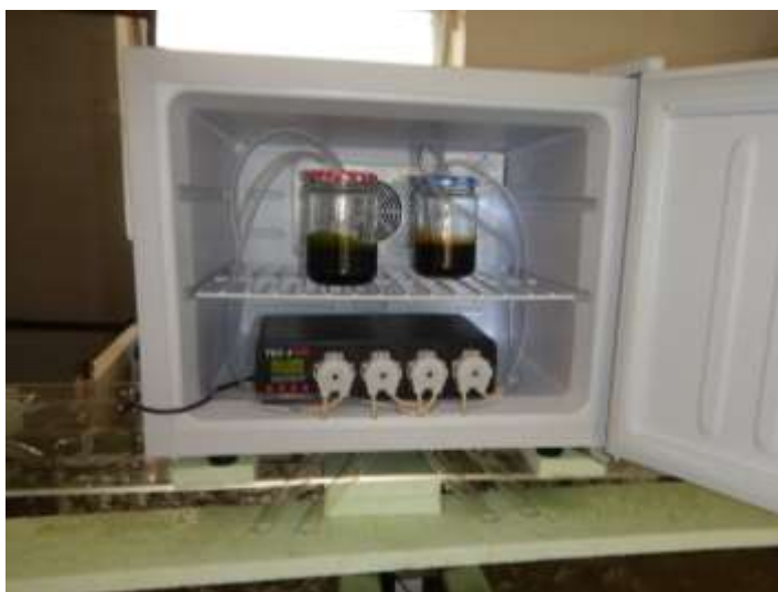
Abb. 3 Automatische Fütterungsanlage der Jungmuschel-Fließrinnen.
