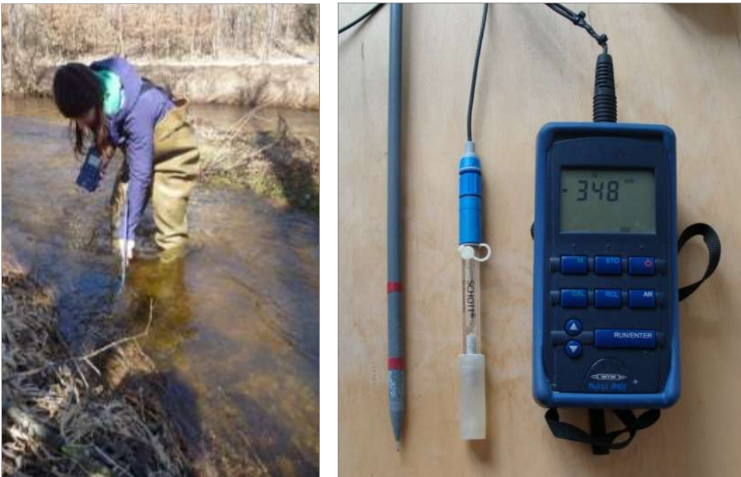
Abb. 18 Bestimmung des RedOx-Potentials mit dem RedOx-Meter nach der Methode von GEIST & AUERSWALD (2007).
